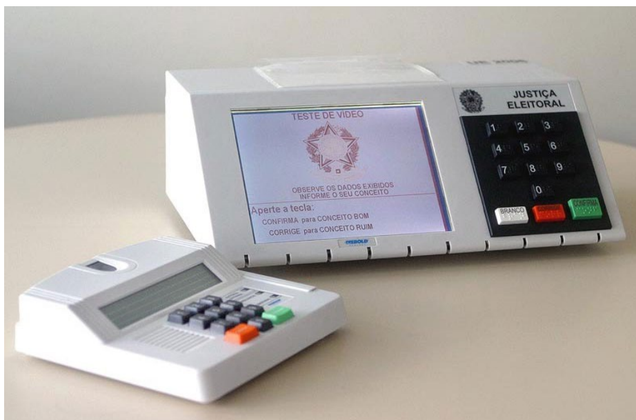
Рис.17.21. Бразильский кнопочный аппарат для голосования и сканер отпечатков пальцев (фирма «Diebold», США)
