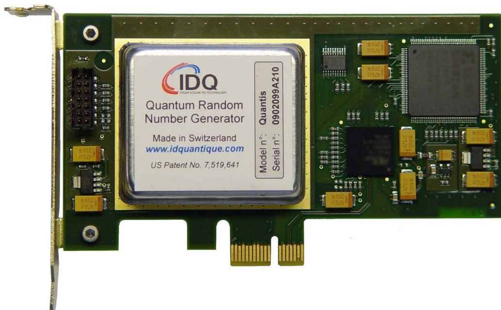
Рис.6.7. Квантовый генератор случайных чисел [www.idquantique.com/random-number-generation/overview]
