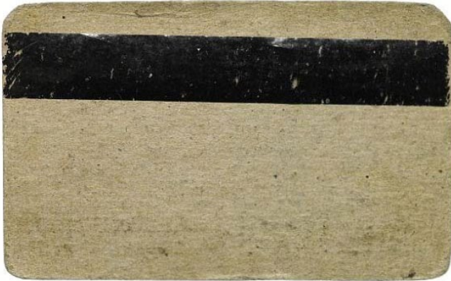
Рис.13.6. Один первых прототипов карты с магнитной полосой на картонной основе
