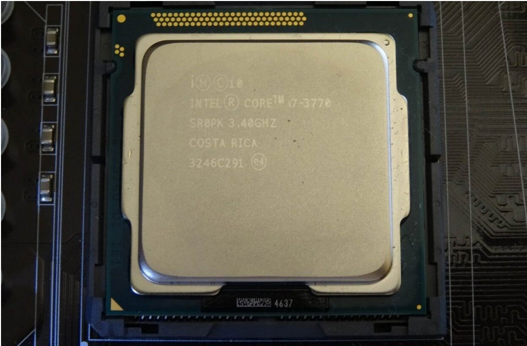
Рис.6.3. Микропроцессор Core i7-3770 с архитектурой Ivy Bridge и инструкцией генерации случайных чисел RdRand
